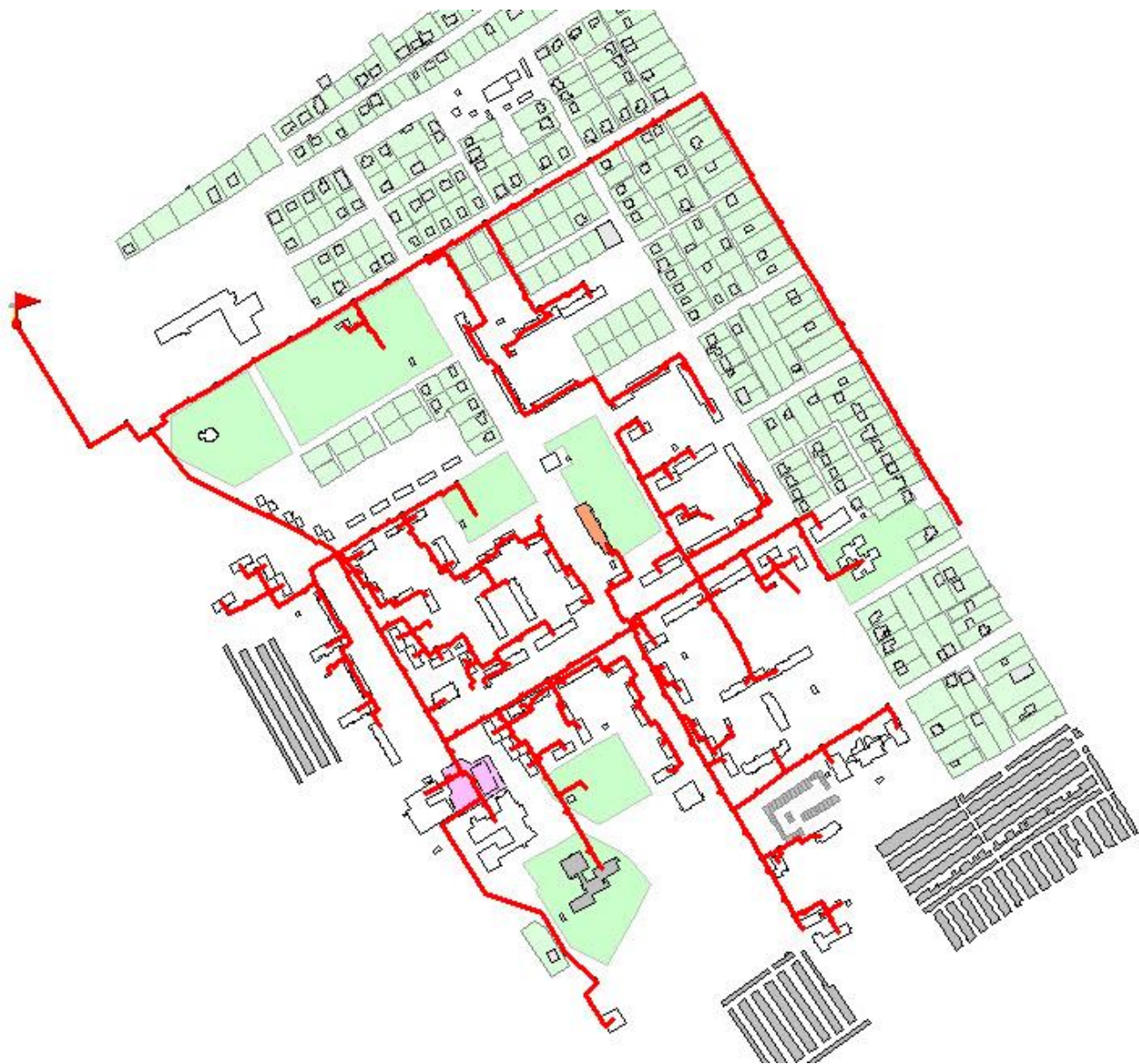
Рисунок 44 – Тепловая сеть от котельной БМК-34
