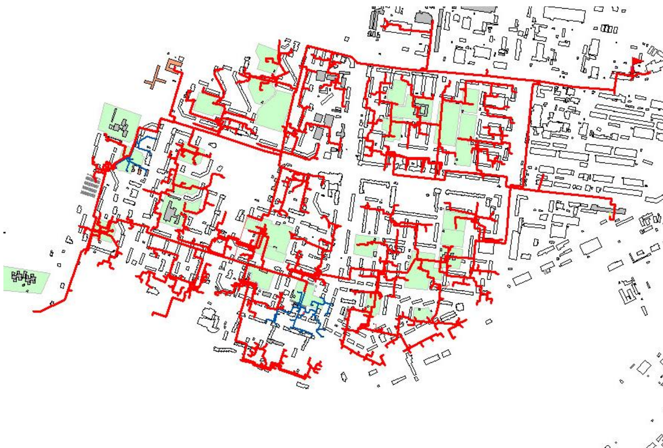
Рисунок 49 – Тепловая сеть от Котельной № 2
