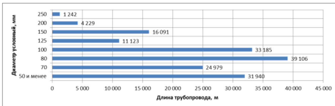
Рисунок 3.7 – Распределение протяженности трубопроводов сетей гвс по диаметрам
