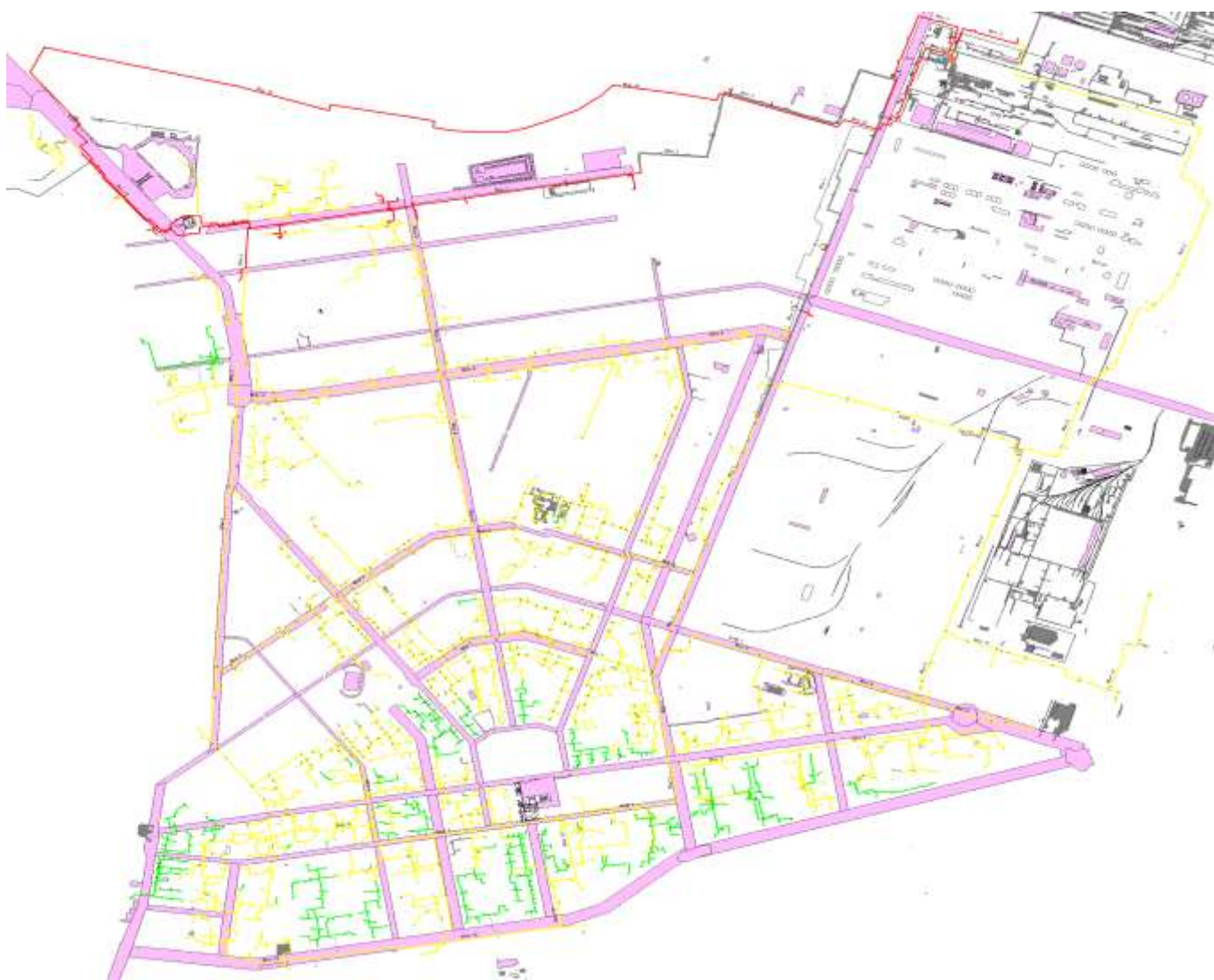
Рисунок 74 – Располагаемый напор в трубопроводах системы теплоснабжения ТoТЭЦ
