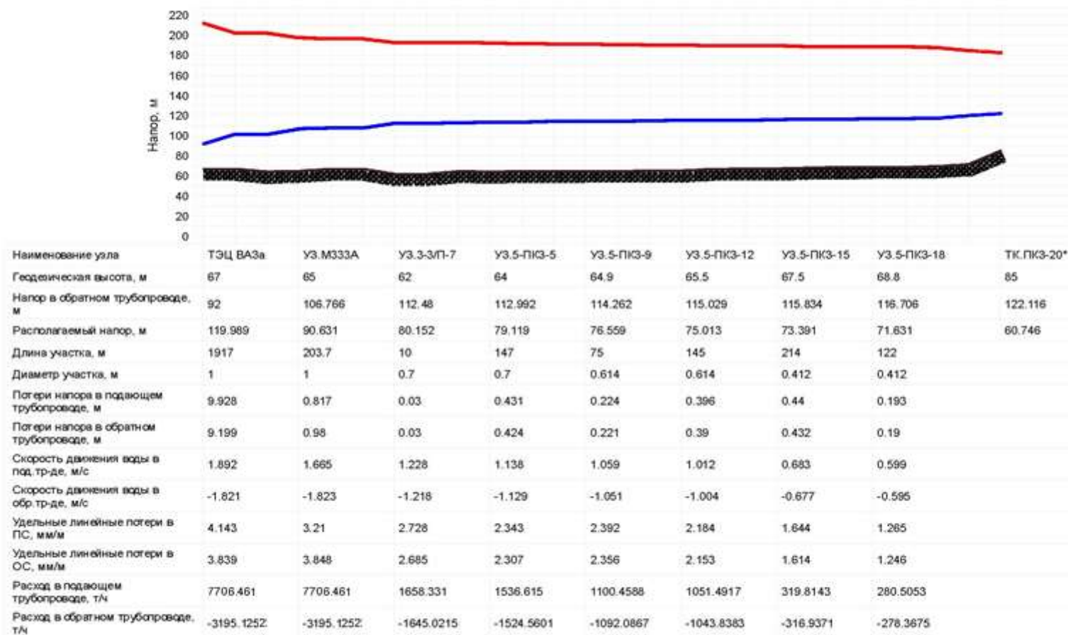
Пьезометрический график от «ТЭЦ ВАЗа» до «ТК.ПКЗ-20*»
