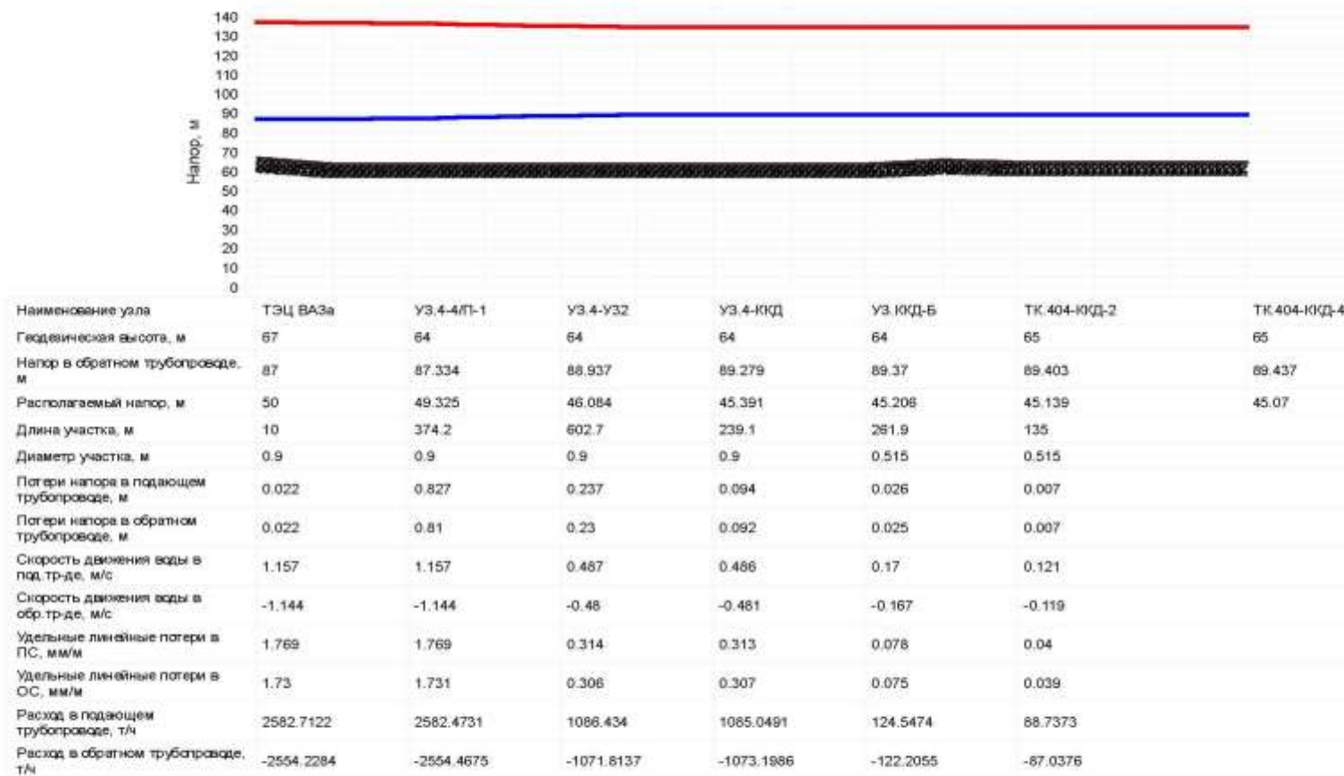
Пьезометрический график от «ТЭЦ ВАЗа» до «ТК.404-ККД-4»
